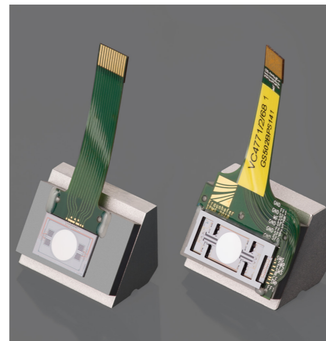
▲ 1D-MEMS-Scanner, identische Apertur 5 mm links: 1D resonant, rechts: 1D quasistatisch
